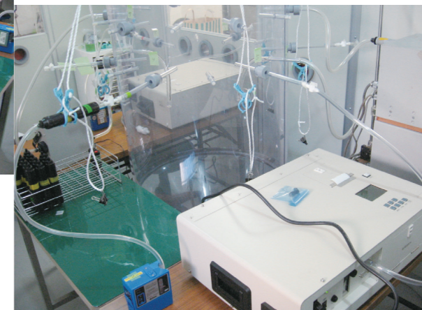
アスベスト測定器「DAECOM-S」据え置き型繊維状粒子測定機として、工場、長期間のアスベスト除去工事現場等に使用することが可能
