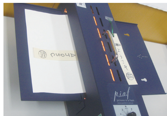
資料作成に使用した立体コピー機：黒い部分に熱を加えると盛り上がり、指先で触知できる
